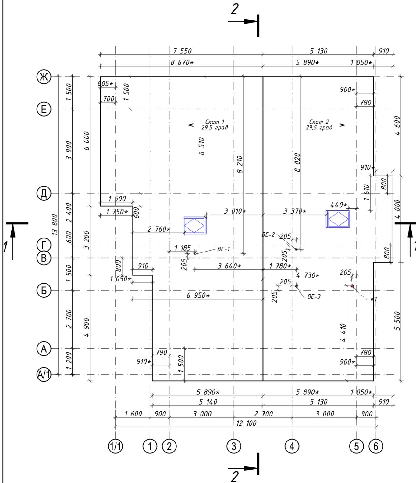
1. Отметки коньков даны по покрытию кровли, с учетом всех конструктивных элементов.
